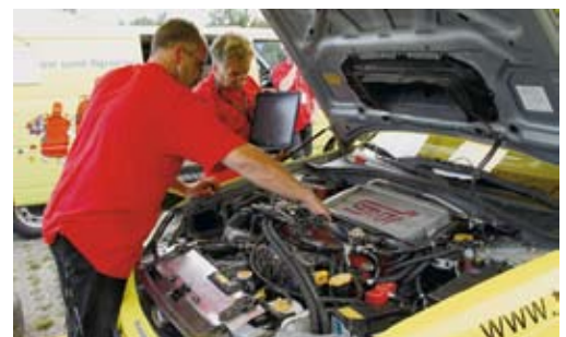
»» Per EDV-Steuerung wurde der Motor auf Fehler überprüft.
